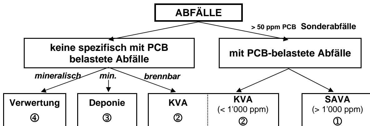
Mit PCB-belastete Abfälle gelten bei Handhabung und Transport als **Gefahrgüter** und bei der Entsorgung als **Sonderabfälle**. Sonderabfälle dürfen gemäss den Vorschriften zur Sonderabfallentsorgung nur mit Begleitschein an Unternehmen zur Entsorgung übergeben werden, die dazu über eine Empfängerbewilligung verfügen.
