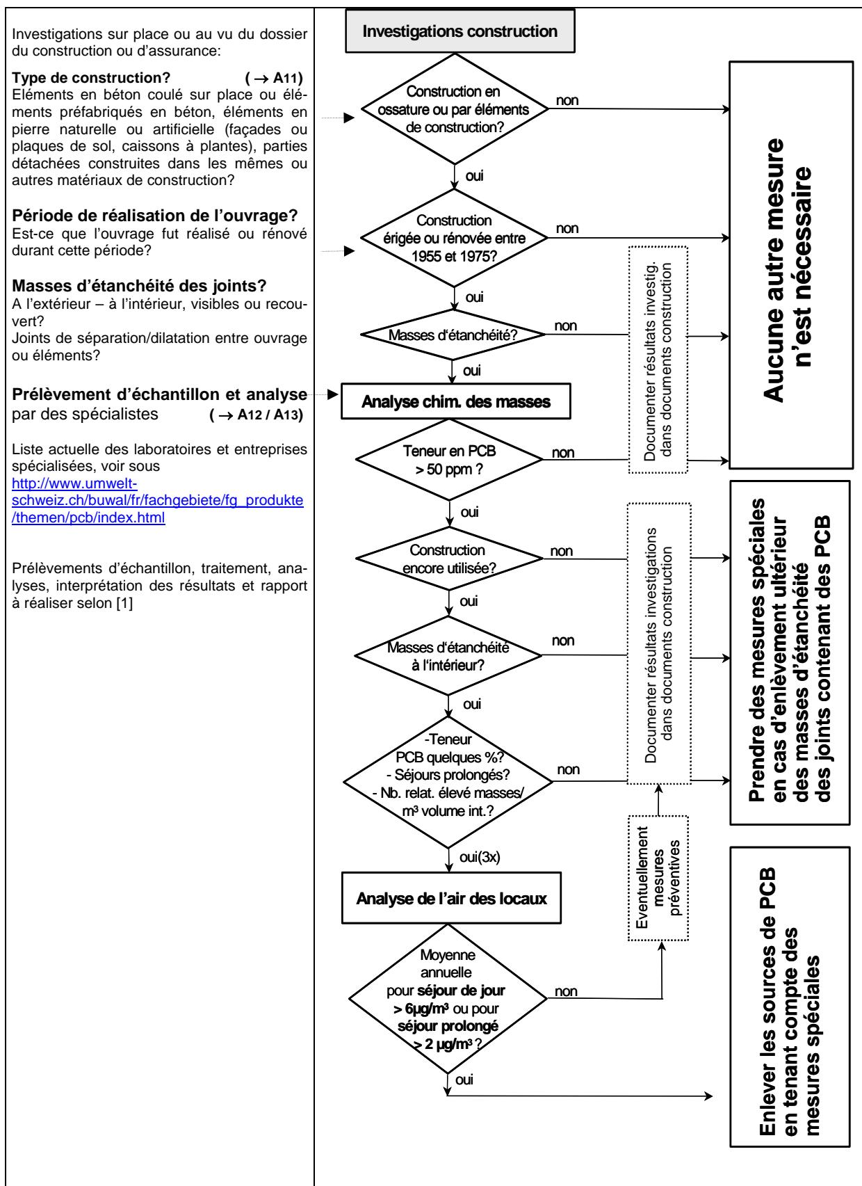
**A11** La première partie des **investigations à effectuer sur l'ouvrage** selon le schéma ci-dessus nécessitent des connaissances particulières en construction et un contrôle sur l'ouvrage (planifier le temps nécessaire!), si les questions ne peuvent pas être résolues en consultant le dossier de construction.
