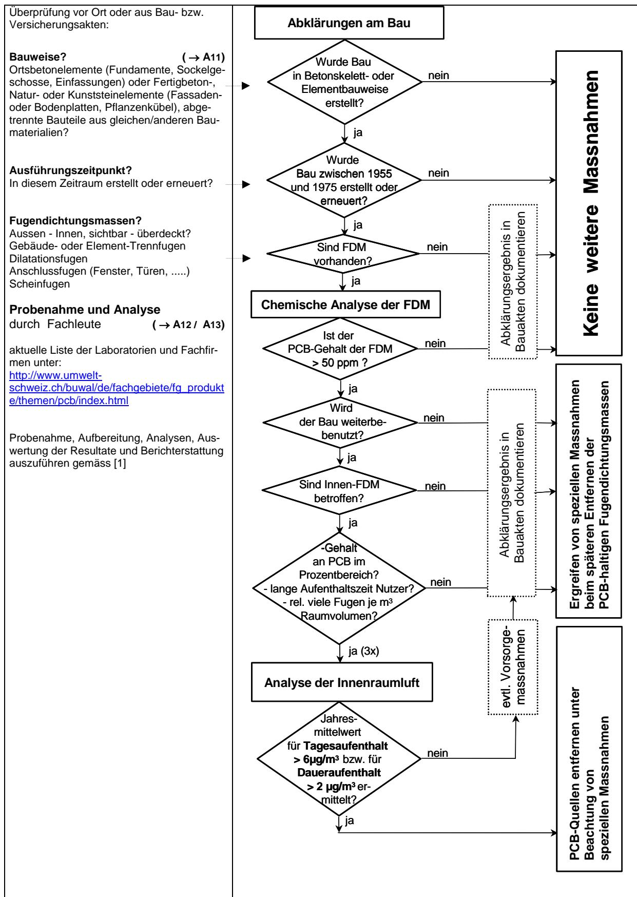
**A11** Der erste Teil der gemäss obenstehendem Schema auszuführenden **Abklärungen am Bau** erfordert bautechnische Kenntnisse und eine Überprüfung am Bau (Zeit dafür einplanen!), falls die Fragen aus den Angaben in den Bauakten nicht eindeutig beantwortet werden können.
