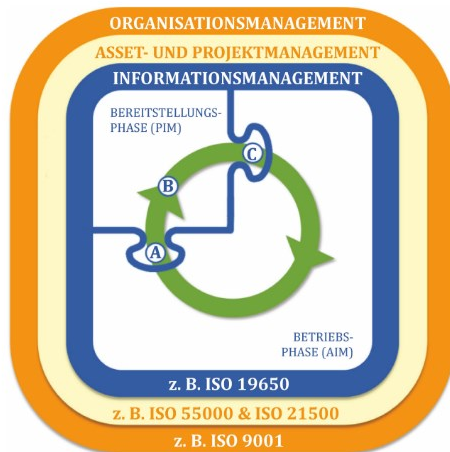
Abbildung 2: Informationsmanagement im Kontext eines umfassenderen Managementsystems (ISO 19650-1 Bild 3). Legende: AIM Asset-Informationsmodell, PIM Projekt-Informationsmodell
